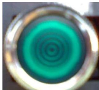
Рисунок 39. Кнопка "Пуск"
