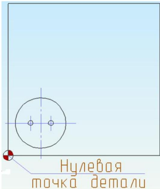
Рисунок 43. Нулевая точка детали
