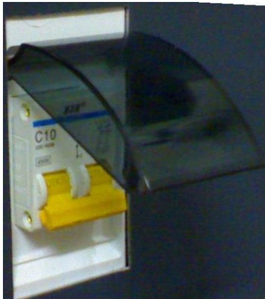
Рисунок 38. Автомат электропитания станка
