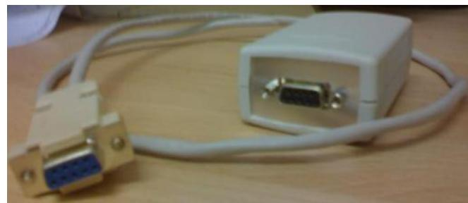
Рисунок 30. Программатор (устройство записи на КВП).
