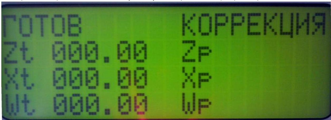
Рисунок 41. Индикация ЖК-дисплея при работе в "Ручном" режиме
