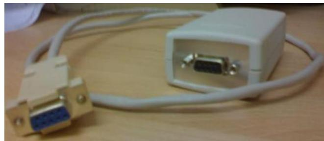
Рисунок 31. Программатор (устройство записи на КВП).
