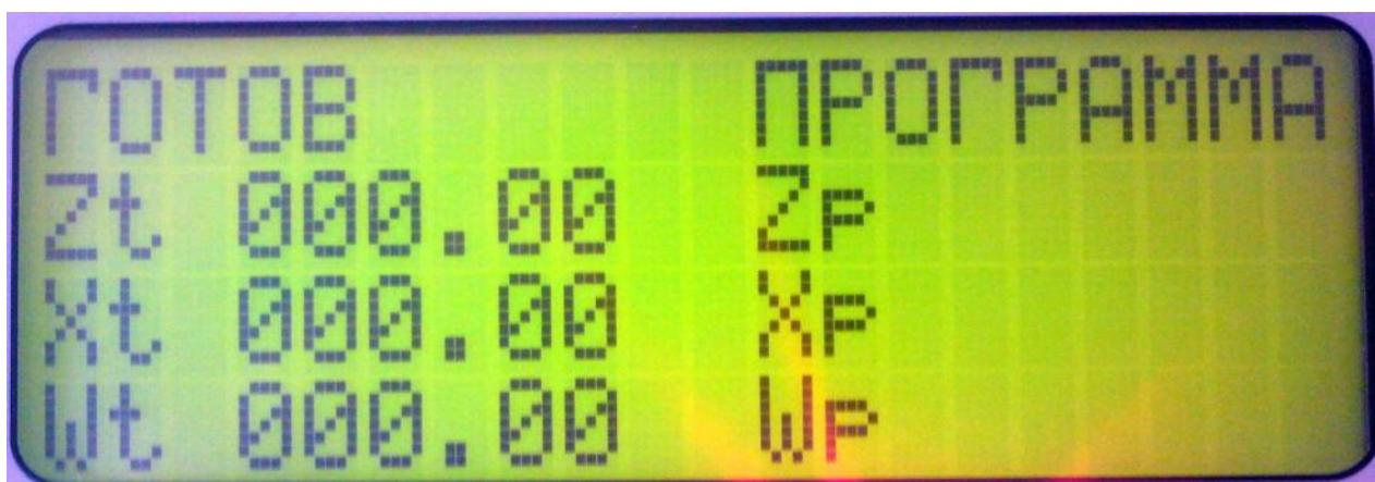
Рисунок 40. Индикация ЖК-дисплея при включении станка
