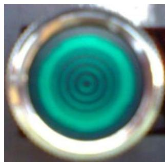
Рисунок 39. Кнопка "Пуск"
