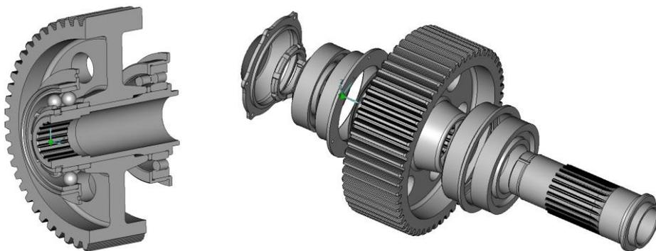
Рисунок 57 – Аксонометрия сборки – разборки промежуточного вала
