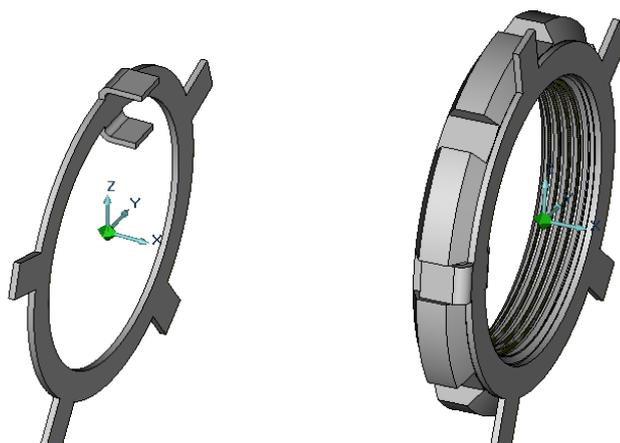
Рисунок 32 – 3D модели пластинчатой шайбы и круглой гайки с резьбой
