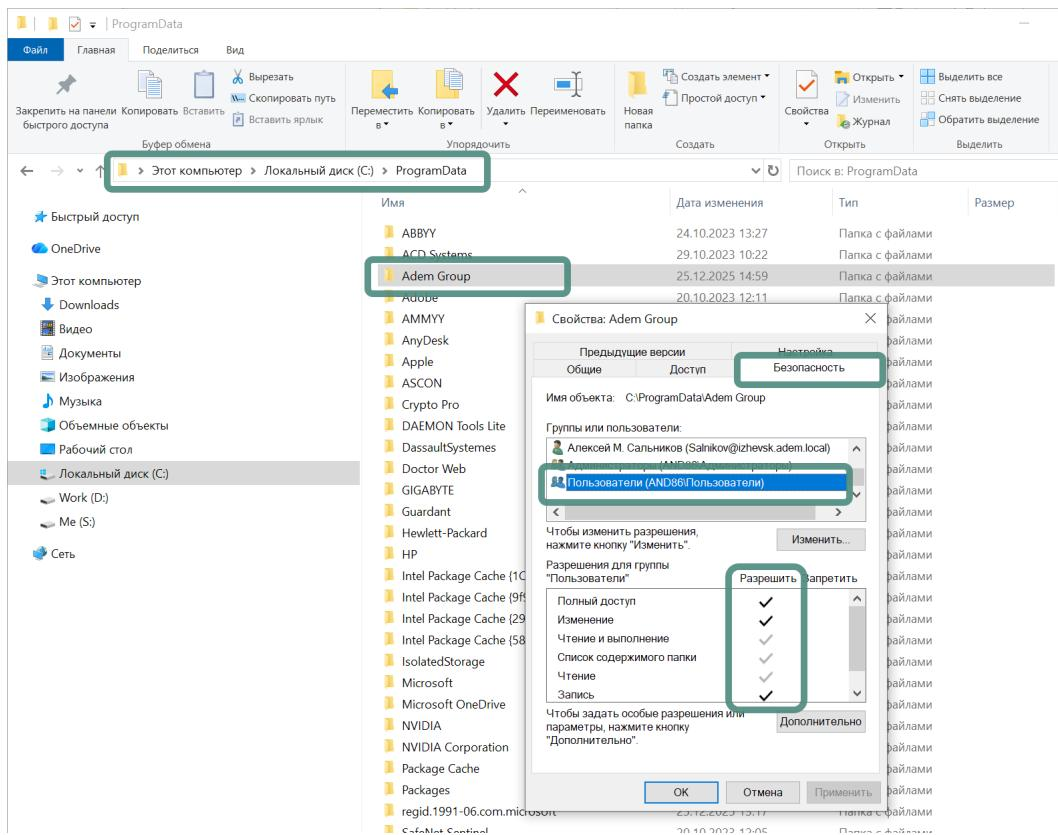
11. После завершения процесса инсталляции и настройки прав доступа к рабочим папкам приложения ADEM CAM, запустить систему КОМПАС и воспользовавшись штатными средствами системы КОМПАС-3D «Добавить приложение» ADEM4KOMPAS в перечень установленных на рабочем месте.
