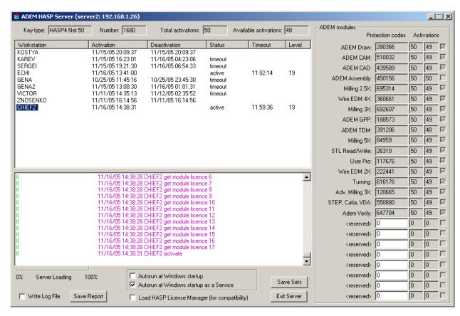
В титульной строке диалога отображается, помимо имени AdemHaspServer'а, имя компьютера сервера сетевой защиты и его IP адрес. Имя или адрес могут быть использованы для адресации ADEM с рабочих станций (рабочих мест) к серверу. В диалоге настройки сетевой защиты ADEM имя или адрес вводятся в поле "Selected Server":
