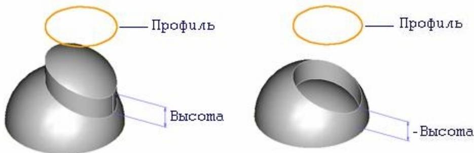
В результате выполнения данной операции происходит смещение участка одной или нескольких поверхностей указанного 3D тела попавших внутрь проецируемого контура. Если поверхность является единственной и плоской, то возможно задание угла наклона стенок добавляемого/удаляемого участка поверхности.
