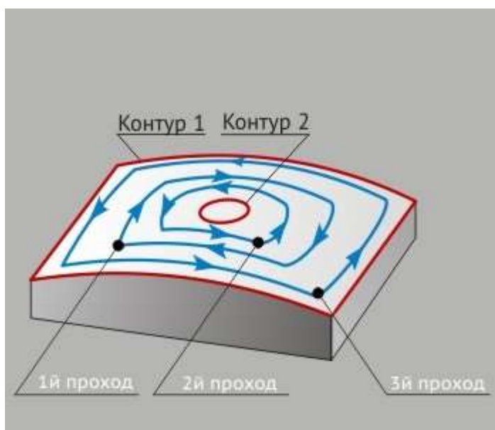
Обработка из центра с изменением направления
