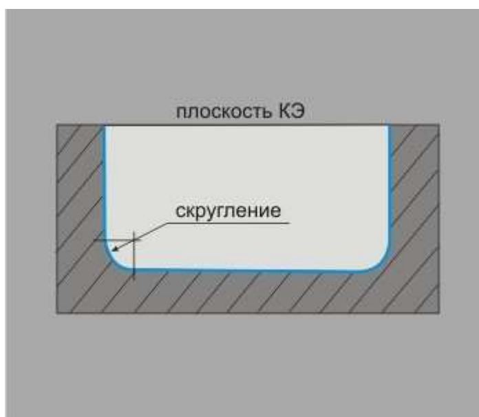
Стенки и дно КЭ сопряжены поверхностью определённого радиуса кривизны
