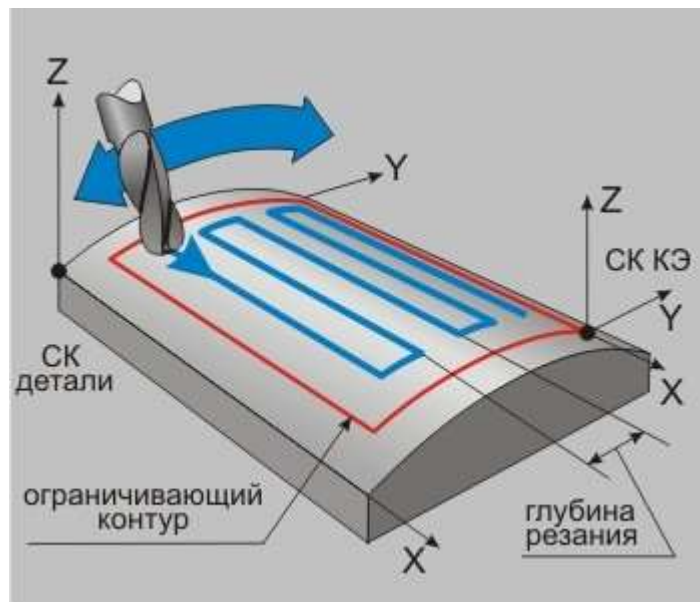
«Шаг» в 4X-фрезеровании
