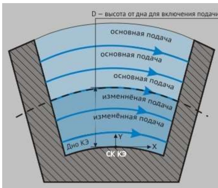
На высоте, равной D , инструмент переключается на подачу для обработки дна
