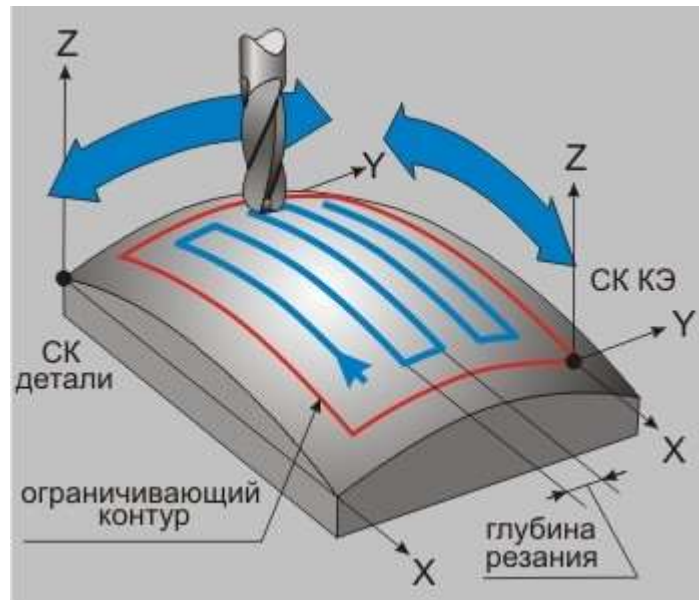
«Шаг» в 5X-фрезеровании
