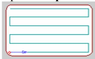
Рис. 24. Тип обработки «Зигзаг»
